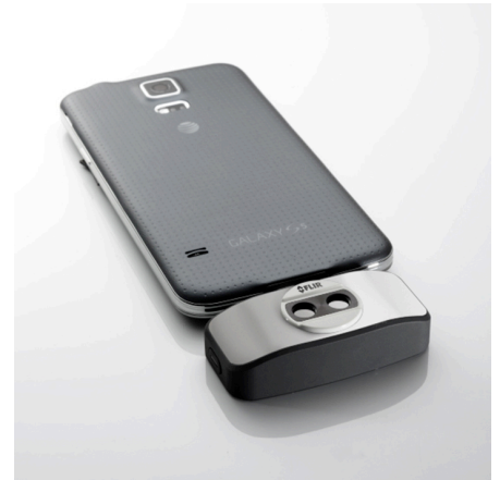
그림 37.3 2015년: FLIR One. iPhone 및 휴대폰에 장착하는 액세서리로 무게는 90g입니다.
