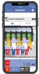
GENNECT Cross 를 사용하면 현장에서 보고서를 작성할 수 있습니다. 조인트 박스 사진을 촬영하고 그 이미지 위에 측정값을 배치합니다. 측정 위치와 측정값을 한눈에 볼 수 있는 자료가 됩니다.
