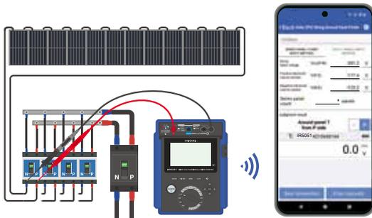
절연 불량을 확인한 스트링 중에서 지락된 태양광 패널을 찾습니다. 해당 단로기의 전압을 측정하여 GENNECT Cross 로 전송하면 지락이 발생한 패널의 위치를 표시합니다. IR5050/IR5051 은 DC 2000 V 까지 안전하고 정확하게 전압을 측정할 수 있습니다.
