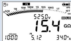
$$PI \text{ 또는 } DAR = \frac{t_2 \text{ 저항값}}{t_1 \text{ 저항값}}$$
