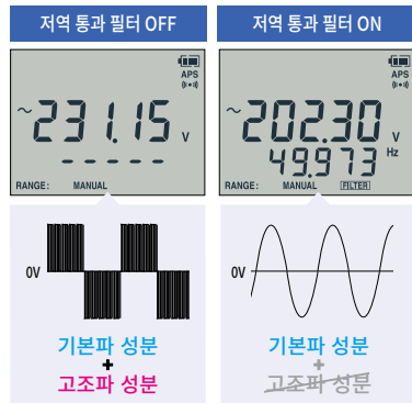
인버터 2 차측의 출력전압을 저역 통과 필터 기능으로 정확하게 측정
