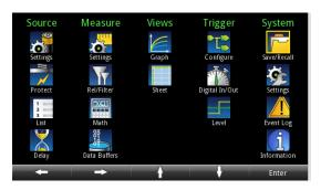
이 화면에서 소스, 측정, 보기, 트리거 및 시스템 설정 메뉴를 선택할 수 있습니다. 이러한 메뉴를 사용하여 애플리케이션에 대해 장비를 설정하는 옵션을 선택할 수 있습니다. 탐색 컨트롤을 사용하거나 화살표 키를 사용하여 아이콘을 강조 표시하여 메뉴 항목을 선택합니다. 그런 다음 ENTER를 누릅니다. 측정 아래에서 **Settings**(설정) 옵션을 선택하면 사용 가능한 옵션의 예가 아래에 표시됩니다.
