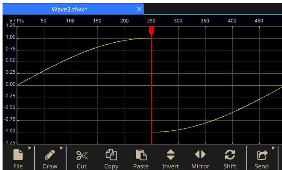
그림 132: ArbBuilder에서 잘라낼 파형 데이터 강조 표시
