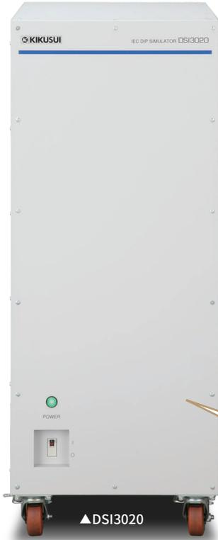
DSI 시리즈는 IEC 61000-4-11 Ed3.0 (2020) 규격을 준수한 '전압 딥/순간 정전 및 전압 변동 내성 시험 시스템'을 구성하기 위한 옵션 유닛입니다. 당사 교류 전원 PCR-LE/LE2, PCR-WEA/WEA2 시리즈와 조합해서 사용할 수 있습니다. 시험에서 요구되는 고속 전압 전환(상승 시간 1 $\mu$ s~5 $\mu$ s), 전압 강하(0%, 40%, 70%, 80%) 및 상전압/순간 전압 강하 시험에 대응합니다.
