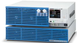
▲PLZ1205W(상)와 부스터 PLZ2405WB(하)에 의한 3.6kW 시스템 사례
