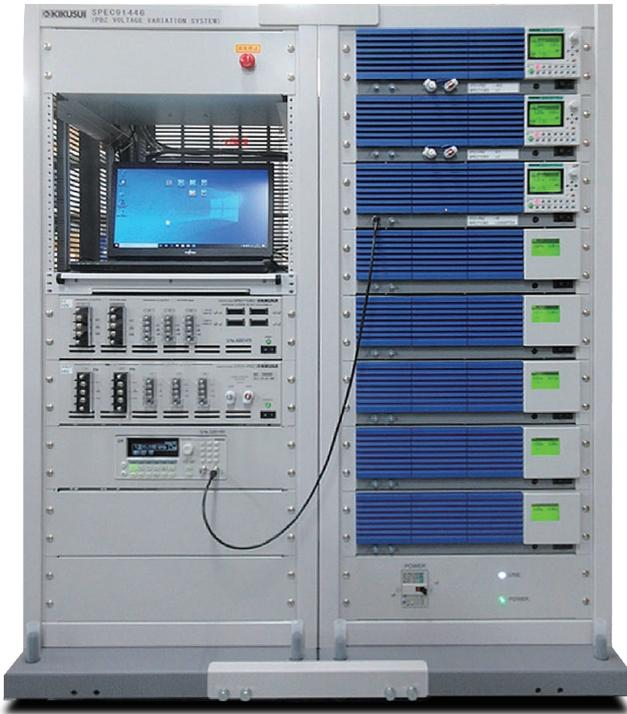
본 시험 시스템은 ISO7637-2 규격, ISO16750-2 규격, LV124/148 규격 및 각 자동차 제조업체의 민간 규격에서 요구되는 전원 전압 변동 시험에 대응한 시험 시스템입니다. 본 시스템의 특징은 PBZ 시리즈의 출력을 최대 5계통 까지 ON/OFF할 수 있는 스위치 박스 OT01-PBZ 및 순간 차단 시험을 위해 필요한 스위치 박스 OT02-PBZ와 인텔 리전트 바이폴라 전원 PBZ 시리즈의 시퀀스 동작을 제어 하는 어플리케이션 소프트웨어를 준비하여, 각 규격에 대 응한 시스템을 구축한 점입니다.
